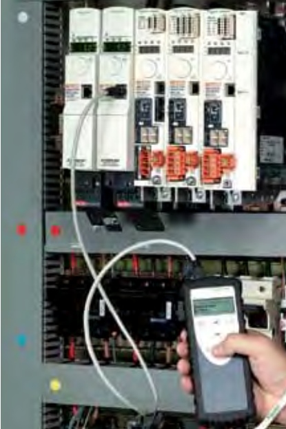
Multi-Loader birden fazla sürücünün konfigürasyon dosyalarını SD hafıza kartına kaydetme ve yükleme
